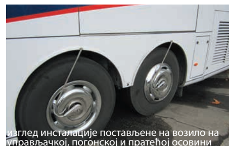
изглед инсталације постављене на возило на управљачкој, погонској и пратећој осовини
